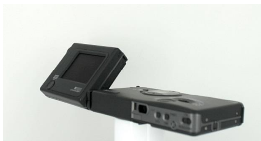
Slika 15 Ricoh RDC-1 digitalni fotografski aparat sa mogućnošću snimanja videa [10]
