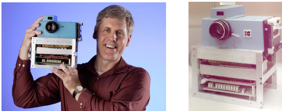
Slika 2 S. Sasson s prvim CCD senzorom i fotografskim aparatom koji ga koristi [7]
