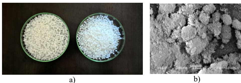
Slika 11 - Materijali: a) PLA (lijevo) i PCL (desno), b) nanočestice SiO 2 (pri povećanju 1600x)
