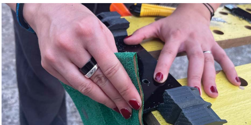
Slika 17 - Brušenje rubova adaptera
